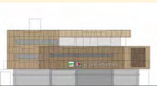
Das Firmengebäude der E-Werke im Ortszentrum bekommt eine neue Fassade aus voroxidiertem Kupfer.
